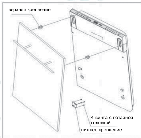
Рис. 4а. Установка декоративной панели.
